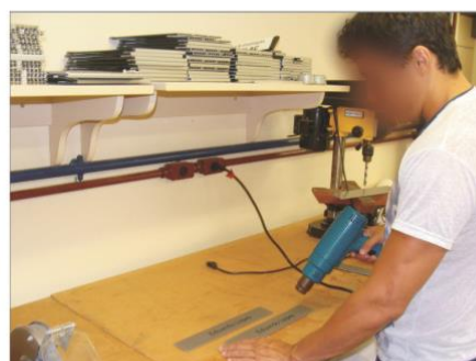
Aquecimento dos adesivos para facilitar a remoção
