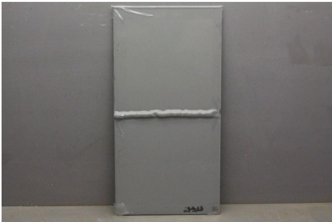
Amostra após 1000 horas de ensaio. Detalhe de superfície.
