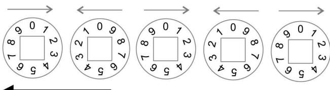
No medidor de ponteiros, inicie a leitura da direita para a esquerda
