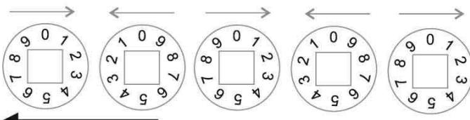
No medidor de ponteiros, inicie a leitura da direita para a esquerda
